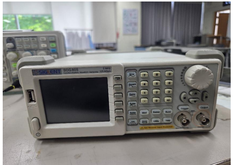
▲ 오실로스코프의 단짝, 파동 발생기(wave generator)
